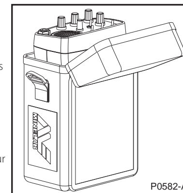
Figure 7 - Montage du boîtier de contrôle dans la sacoche "Hipmount"
