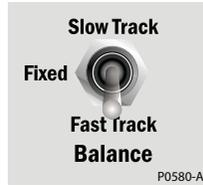
يتيح لك مفتاح ضبط التوازن اختيار إما وضع التتبع التلقائي السريع أو وضع التتبع التلقائي البطيء أو التوازن الأرضي الثابت. ويوفر Eureka Gold في كلا الوضعين التلقائيين ضبط التوازن الأرضي تلقائيًا. وهذا يعني أن جهاز الكشف سيستمر بتعديل نفسه للحفاظ على التوازن الأرضي مما يضمن أن الجهاز يبحث طوال الوقت عند أقصى عمق ممكن له. يتسبب التتبع السريع في استجابة توازن التربة بشكل أسرع إلى الظروف الأرضية المتغيرة، بينما يوفر التتبع البطيء الاستجابة في نصف هذا الزمن.
