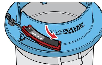
Abaissez ensuite le côté gauche du boîtier de commande jusqu'à ce que le clip d'encliquetage situé à gauche s'enclenche.
