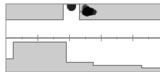
Die Zielverfolgung einer kanadischen 10-Cent-Münze von 1998 (angenommen) und eines direkt daneben liegenden Nagels (abgelehnt).
