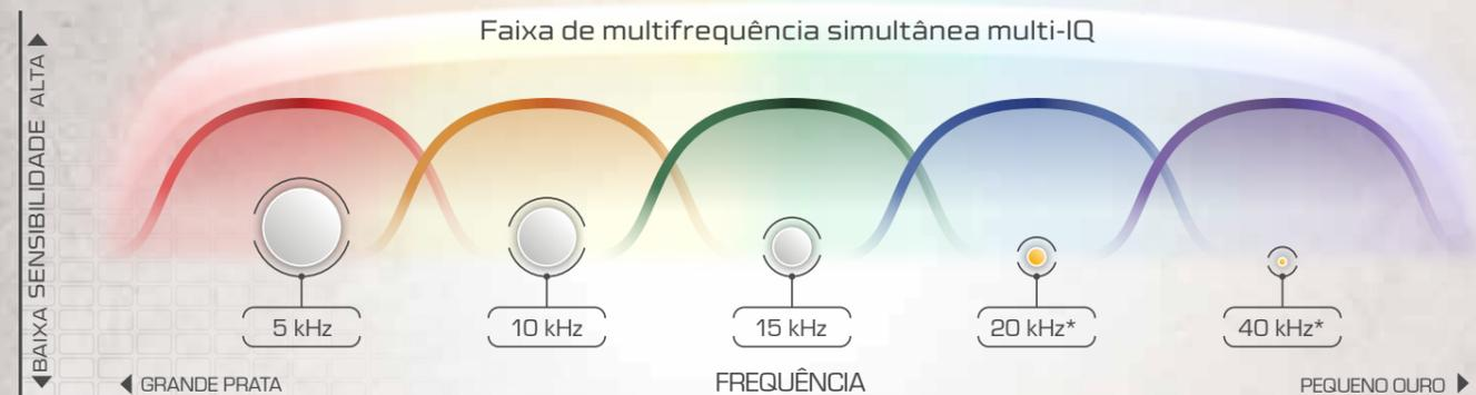
\*20 kHz e 40 kHz não estão disponíveis como frequências de operação únicas no EQUINOX 600. A faixa de frequência Multi-IQ mostrada aplica-se a Equinox 600 e 800. Este diagrama é apenas representativo. Os níveis reais de sensibilidade dependerão de tipos e tamanhos do alvo, condições do solo e configurações do detector.
