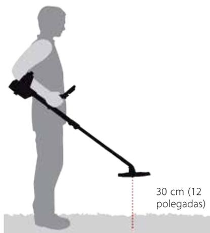
**Figura 17 – Posição correta do detetor para realizar o Cancelamento de ruído**
