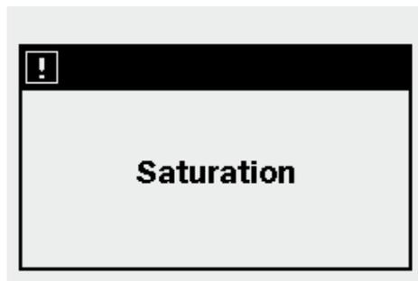
**Nota:** Quelques fois, il est possible qu'une grosse masse métallique, située à proximité de la tête de détection, crée une saturation temporaire de l'électronique du détecteur. Quand cela arrive, le E-Trac affiche le message "Saturation" et émet un signal sonore particulier, qui se répétera jusqu'à ce que la tête de détection soit éloignée de la cible la saturant.
