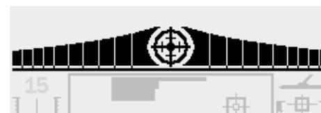
La réponse audio change en tonalité et volume, augmentant quand la cible se rapproche de la tête de détection. La tonalité augmente en fonction de la force du signal et le volume augmente quand la tête de détection se rapproche de la cible.
