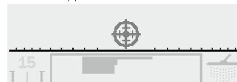
Cet indicateur de niveau évolue des extrémités vers le centre quand la tête de détection se rapproche de la cible. Le réticule deviendra noir quand la cible sera à l'aplomb de la tête de détection.
