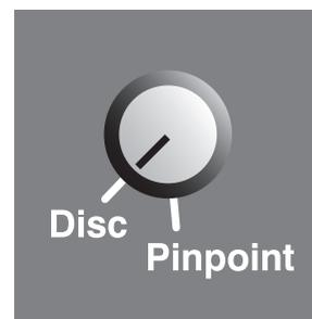
神剑2具有两种不同的探测模式。该控制功能让您在识别模式和精确定位模式(Pinpoint Mode)之间切换。
