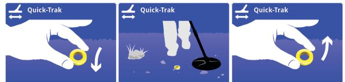
El método para realizar el balance de terreno con la ferrita también se describe, en varios idiomas, en la tarjeta de referencia que se proporciona con los detectores y los accesorios de ferritas.
