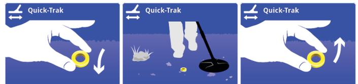
L'aide-mémoire multilingue fourni avec les nouveaux détecteurs et la ferrite en option rappelle également la méthode de compensation des effets de sol à la ferrite.
