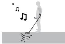
**OBJET TROUVÉ** Lorsqu'il détecte une cible, le détecteur émet un signal sonore et les LED s'allument.
