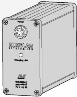
Das Aluminiumgehäuse enthält eine 7.4 V Lithium Ionen Batterie mit einem internen Ladekreislauf. Neben dem Hauptladegerät gibt es noch ein 12 V KFZ Ladegerät. Wenn die Batterie vollständig geladen ist, hält diese ca. 12 Std. oder länger. Das Ladegerät lädt eine leere Batterie in weniger als 5 Std. auf. Teilentladene Batterien brauchen deutlich weniger Zeit zum Laden. Man muss die Batterie nicht vollständig entladen, denn Li- Ionen Batterien können jederzeit geladen werden.
