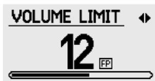
Volume Limit ist die maximale Lautstärke, mit der ein geortetes Objekt angezeigt wird.
