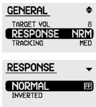
Die Response- uktion erlaubt Ihnen den normalen Tonverlauf bei Ortung eines Objekts umzukehren. Normalerweise wird ein großes/tief liegendes Objekt mit einem fallenden und dann ansteigenden Ton angezeigt. Wenn Sie für große und tiefliegende Objekte einen umgekehrten Tonverlauf vorziehen (gleich wie bei kleinen und oberflächlichen Objekten), verwenden Sie die Response-Funktion, um den Tonverlauf umzukehren (invertieren).
