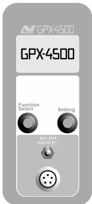
Der On / Off-Schalter befindet sich auf der Rückseite des Bedienteils
