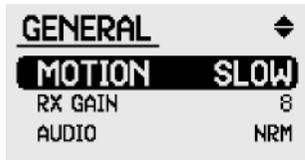
Die Geschwindigkeit, mit der Sie die Spule schwenken, hat einen Einfluss auf die Dauer des Ortungssignals und die Bodenabgleichseinstellung. Das Anpassen der Schwenkgeschwindigkeit an die Geschwindigkeitseinstellung kann Bodenstörgeräusche vermindern.
