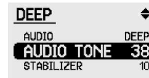
Tone ist die Lautstärke des Threshold (Schwebton), den der Detektor selbst produziert.
