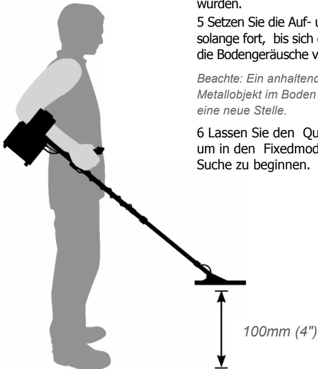
*Durch Heben und Senken der Suchspule im Fixedmodus können Sie jederzeit feststellen, ob die Bodenanpassung noch optimal funktioniert. Das sollten Sie in diesem Modus von Zeit zu Zeit wiederholen.*
