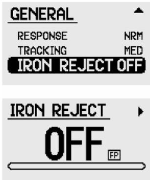
Der GPX- kann viele Objekte aus Eisen ausfiltern, während Edelmetalle angezeigt werden.
