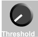
Der Threshold (Schwebton) ist der konstant hörbare Hintergrundton, den der Detektor produziert.
