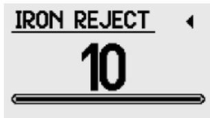
Ein hoher Einstellwert ist sehr effektiv zum Ausblenden von Eisenobjekten. Mit einer hohen Einstellung können einige kleine wünschenswerte Objekte aber mit Eisen verwechselt werden. Diese Einstellung sollte nur in Bereichen mit hohem Schrottanteil verwendet werden oder bei der Verwendung des Detektors in schwach mineralisierten Böden, bei der Suche nach Münzen und antiken Gegenständen.
