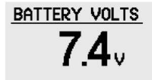
In der Batterie-Test Menüeinstellung wird Ihnen die aktuelle Batteriespannung angezeigt. Diese Einstellung ist jederzeit aufrufbar. Wenn der Akku leer ist, wird Ihnen das mit einer Serie von Alarmsignalen im Minutenintervall angezeigt.
