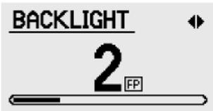
Bei schlechten Lichtverhältnissen kann die LCD-Hintergrundbeleuchtung eingeschaltet werden. Sie können wählen, wie lange die Hintergrundbeleuchtung leuchtet. Zwischen den Einstellungen eins und sechs in Schritten von 10 Sekunden.
