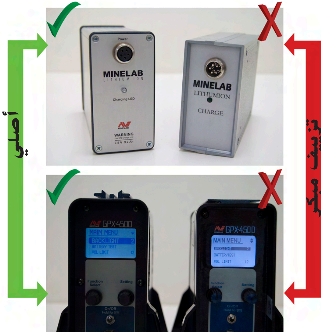
الصورة أ وب: الجهاز GPX-4500 الأصلي والمزور
