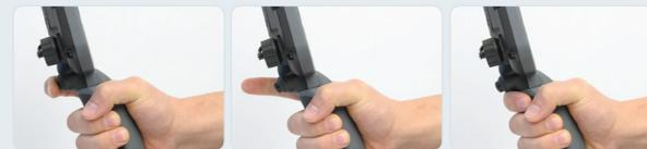
Lorsque le Verrouillage du centrage est activé, appuyez une fois sur le déclencheur pour verrouiller le détecteur en mode Centrage, puis réappuyez pour quitter le mode Centrage.
